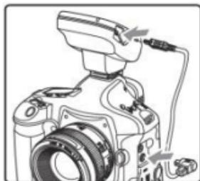
Вы можете использовать удалённый спуск (дистанционное управление съёмкой) со вспышки, установленной в качестве ведомой (для получения подробной информации обратитесь к руководству по работе со вспышкой).
